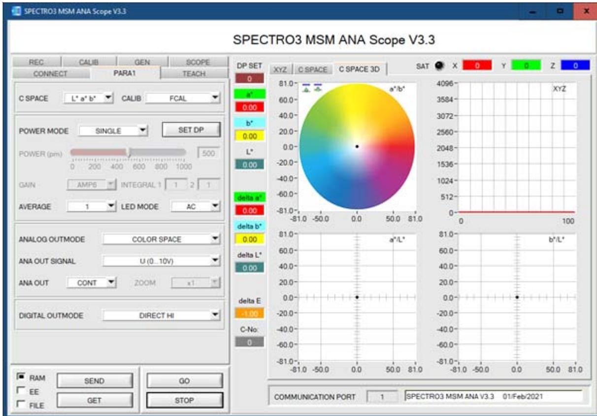
Über die RS232-Schnittstelle (Reiter PARA1) werden Sensorparameter eingestellt, wie z.B.:
