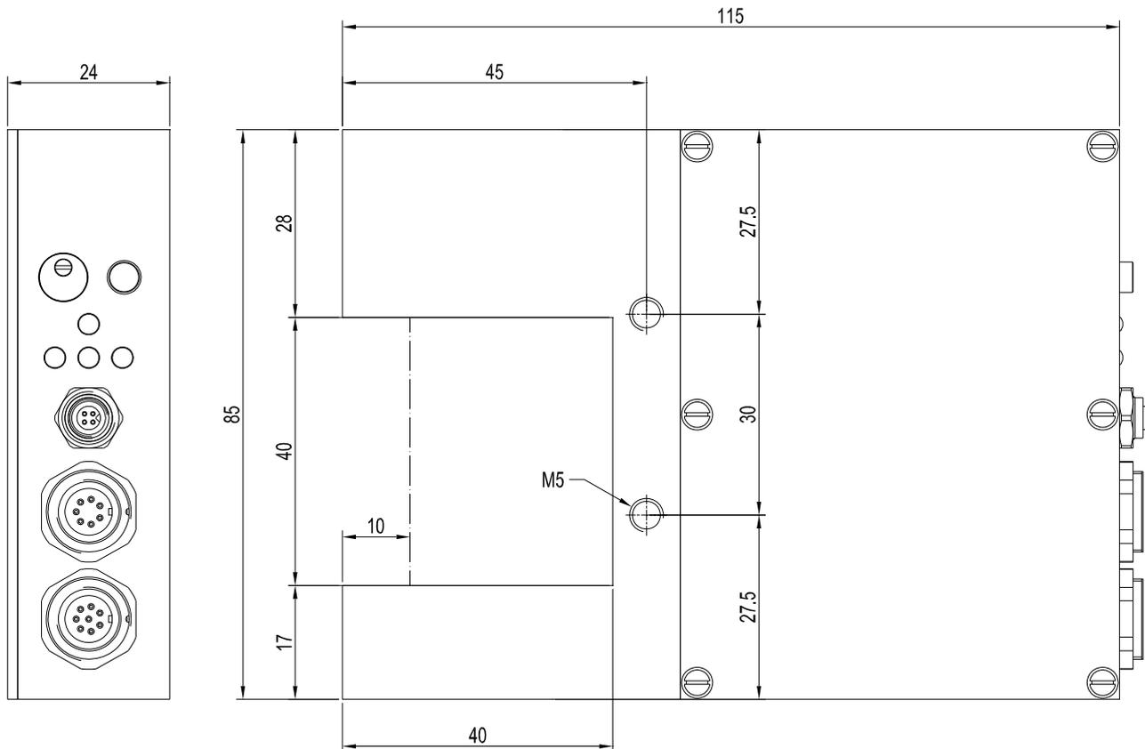
Alle Abmessungen in mm
