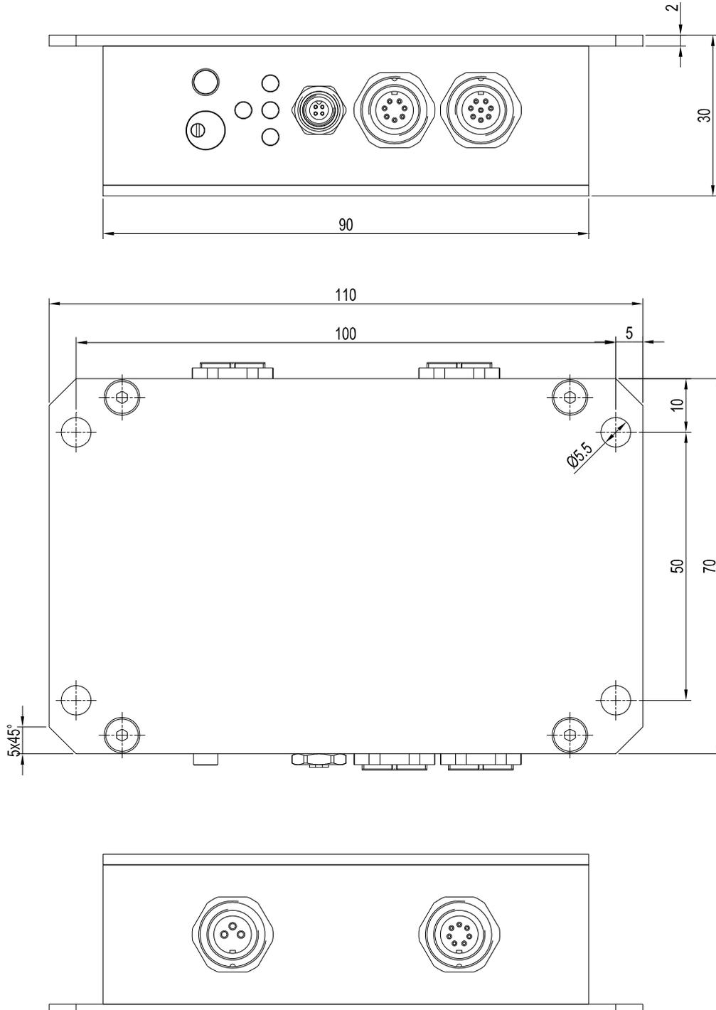
Alle Abmessungen in mm
