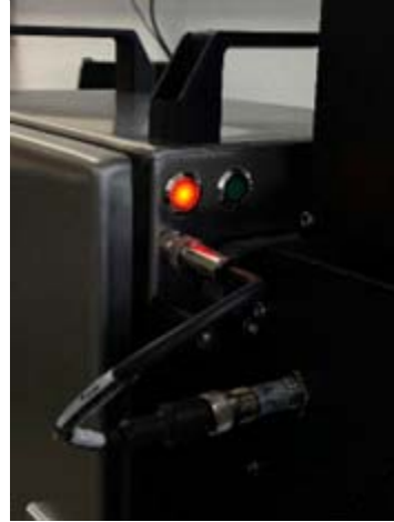
Info über eine rote LED, dass das Karteneinschub- fach leer ist
