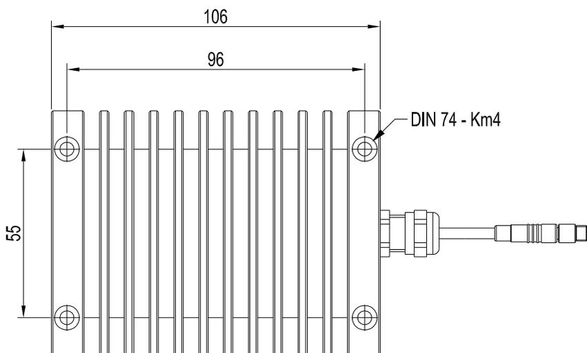
Alle Abmessungen in mm
