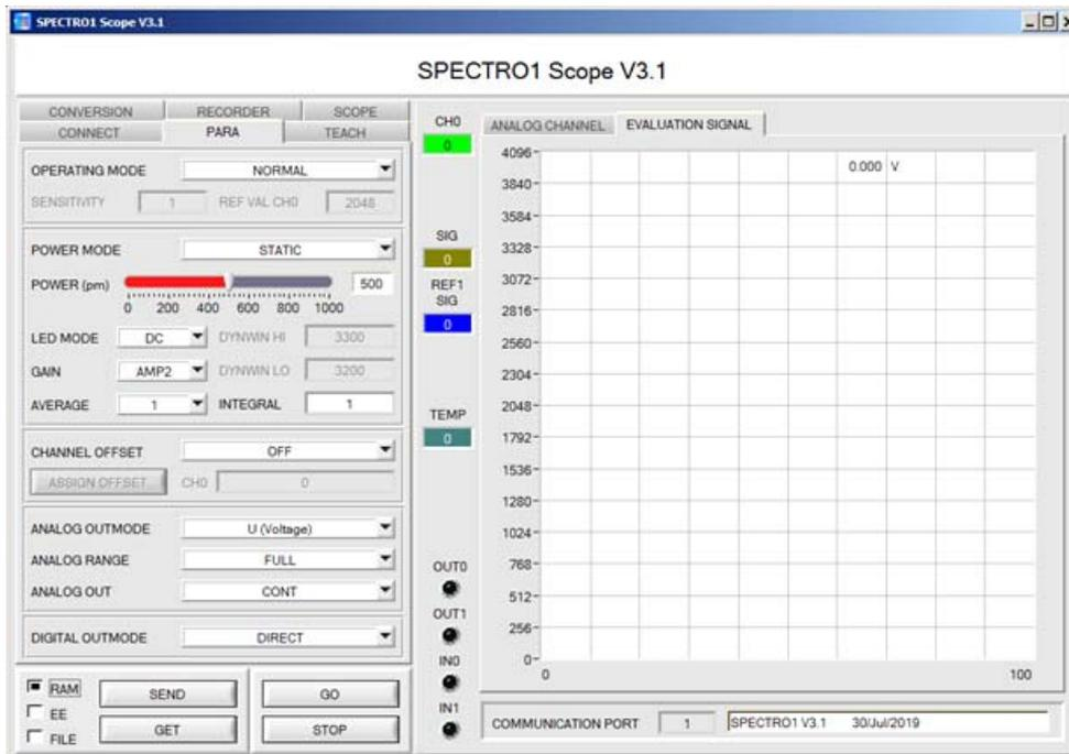
Die PC-Software erleichtert die Parametrisierung, die Diagnose und das Einjustieren des Sensorsystems (Oszilloskop-Funktion). Ferner verfügt die Software über die Funktion eines Datenrecorders, mit dessen Hilfe Daten automatisch aufgezeichnet werden und auf der Festplatte im PC gespeichert werden.
