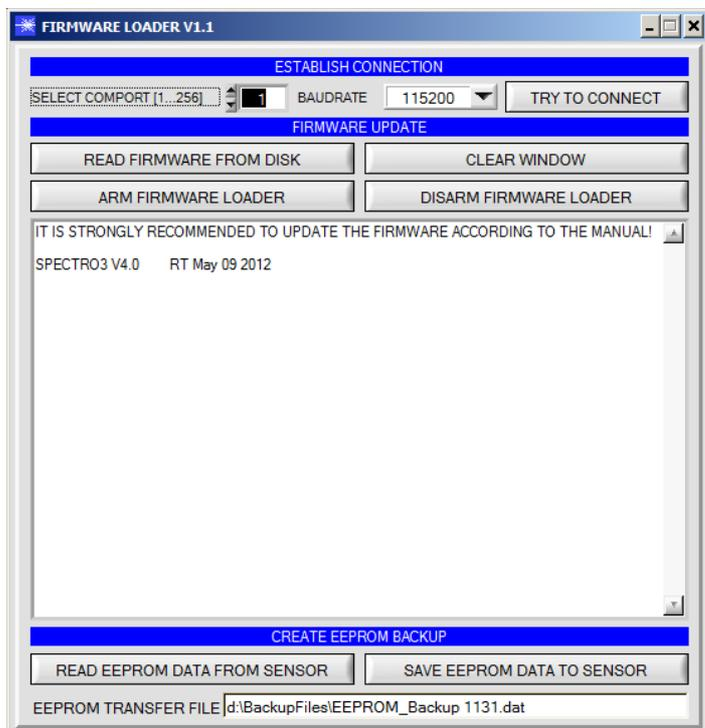
Die Software „Firmware Loader“ ermöglicht es dem Anwender, ein automatisches Firmwareupdate durchzuführen. Das Update wird dabei über die RS232 Schnittstelle durchgeführt.
