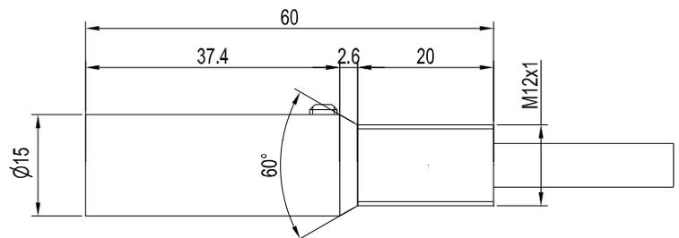
Alle Abmessungen in mm
