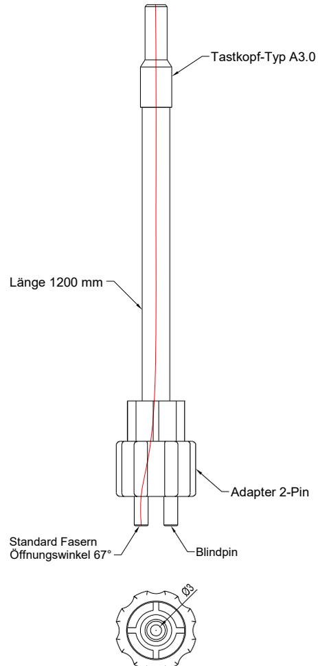
Alle Abmessungen in mm
