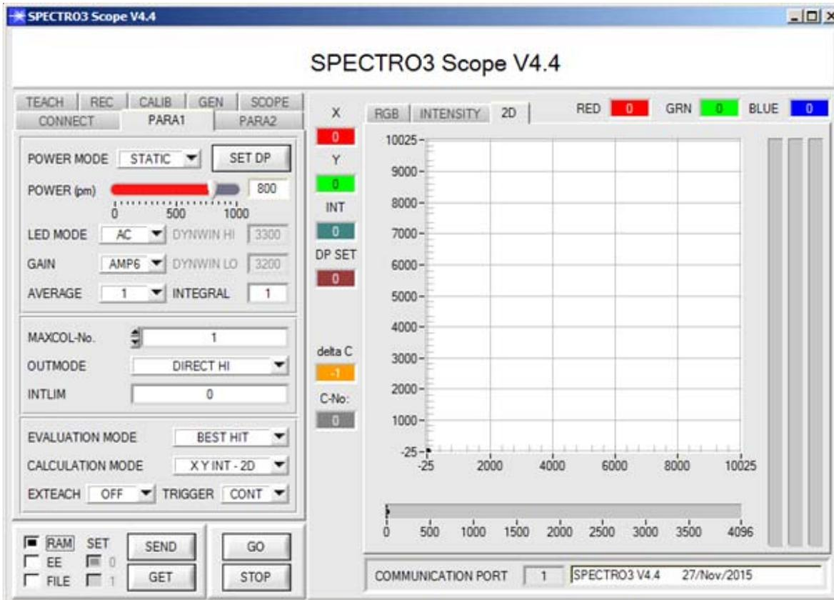
Die Darstellung des Farbwertes unter Windows® auf dem PC in numerischer Form und im Farbdigramm sowie Darstellung der RGB-Werte im Zeitdiagramm. Außerdem werden die aktuellen RGB-Werte als Balkendiagramm zur Anzeige gebracht.
