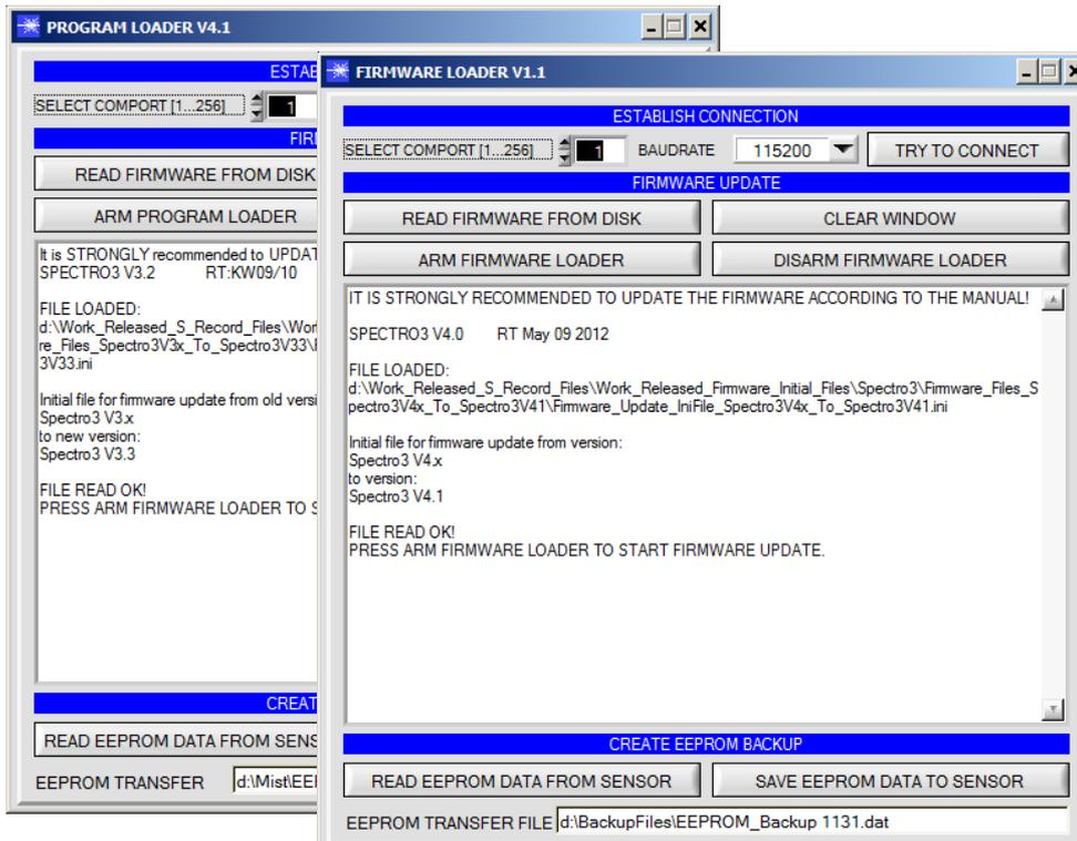
Die Software „Program Loader“ bzw. „Firmware Loader“ ermöglicht es dem Anwender, ein automatisches Firmwareupdate durchzuführen. Das Update wird dabei über die RS232 Schnittstelle durchgeführt.
